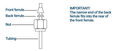
Figure 52. Swagelok nuts and ferrules
