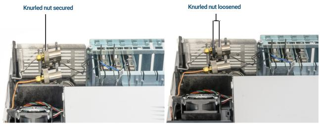
Figure 30. Loosen knurled nut
